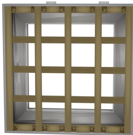
Ansicht von innen mit Holzaussteifung (Holzgitter wird nach dem Ausschalen entfernt)
